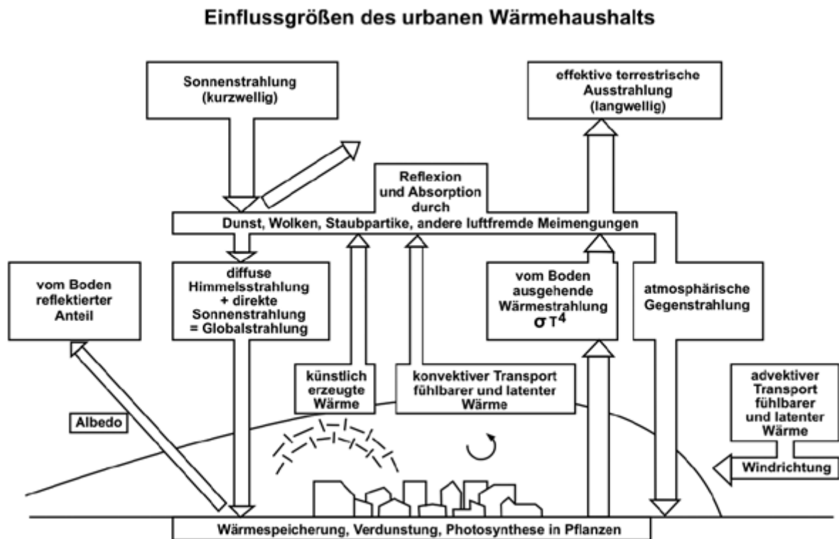
Abb. 11: Einflussgrößen des urbanen Wärmehaushalts Quelle: ROBEL et al., 1978 aus: Städtebauliche Klimafibel, 2012, S. 24
